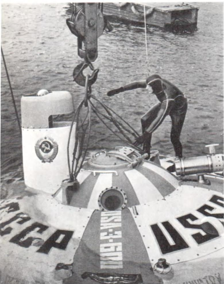
Советская подводная лодка «Оса-3-600». Спуск в глубины Балтики. Крыльчатые движители «Осы» в сочетании с чечевицеобразным корпусом обеспечивают ей исключительно высокую маневренность.
